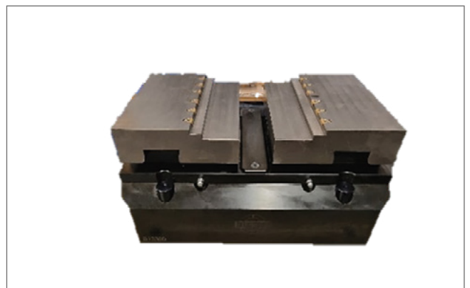
Pendelbacken und direktes formschlüssiges Prägen mit den HM Master Grip Einsätzen
